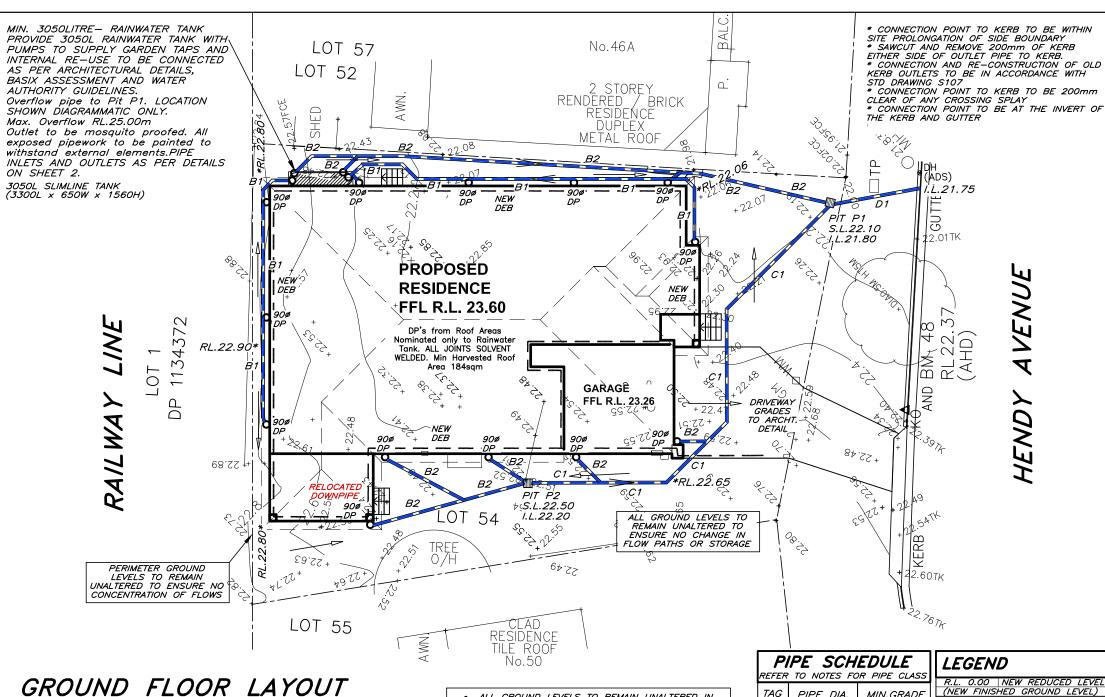
REFER TO SHEET 2 FOR RAINWATER TANK DETAILS. LEAF GUTTER GUARDS OR SIMILAR SCREENING RECOMMENDED TO ALL GUTTERS.
